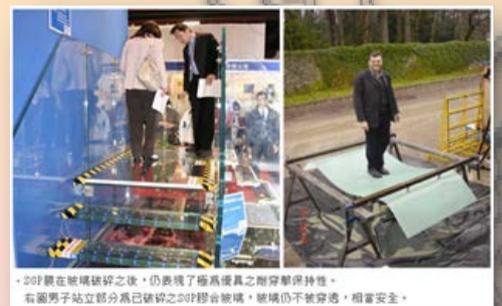
SGP膠在玻璃破碎之後，仍表現了極高優異之耐衝擊保持性，右圖男子站立部分為已破碎之SGP膠合玻璃，玻璃仍不致穿透，相當安全。
