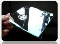
自潔玻璃分為疏水性表面自潔及親水性二氧化鈦分解自潔兩種。 疏水性自潔表面是藉由化學聚合物塗料/電漿離子蝕刻方式,使 玻璃具有特殊表面,液體難以附著或沾溼玻璃表面,當水在其表 面的接觸角度超過150°,滑動角小於20°時髒污即無法附著於玻 璃表面,進而保持玻璃的清潔;接觸角是一個表示疏水性的概念 是疏水性自潔玻璃的重要指標。水在玻璃表面上水面切線和玻璃
